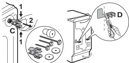
Для того чтобы установить стиральную машину вровень с окружающей мебелью, действуйте, как показано на рис. D.
