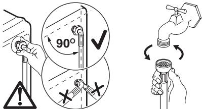
Otevřete kohoutek přívodu vody. Zkontrolujte, zda nedochází k únikům vody.
