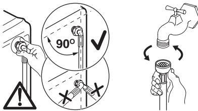
Откройте водопроводный вентиль. Проверьте на отсутствие утечки.
