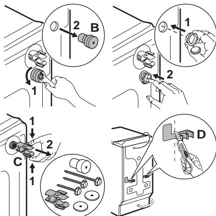
Aby zainstalować urządzenie na tym samym poziomie co przylegające meble, należy postępować zgodnie ze wskazówkami przedstawionymi na rysunku D.
